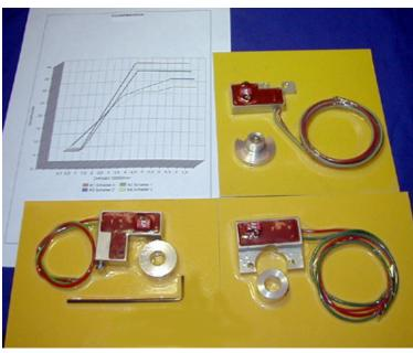
Zündfunken-Verbesserungsfaktor etwa 16 % bis 20 %, der durch Einbau einer Hochleistungszündspule nochmals verbessert werden kann. (*Bild: Laubersheimer*)
