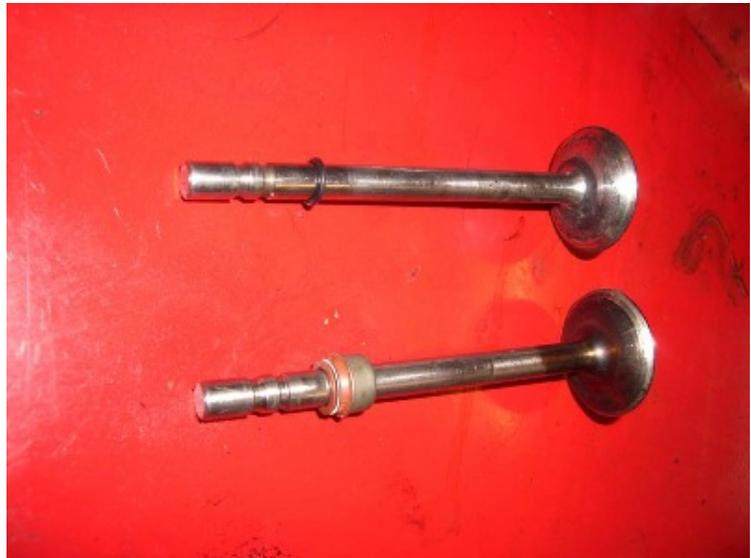
Aber man kann die Führungen mit modernen Schaftabdichtungen versehen, am einfachsten geht das bei ausgebauten Führungen auf der Drehbank, aber auch etwas mühsamer im eingebauten Zustand (natürlich nur bei ausgebauten Ventilen). Ein wesentlicher Schritt, aus unseren Motoren moderne umweltfreundliche Alltagsaggregate zu machen. Näheres dazu seht ihr bereits [HIER](#).
