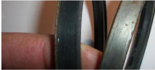
Einpressen in den hinteren Lagerdeckel, der keinen Anschlag für den Ring hatte, genau richtig saß. Später war das nicht mehr erforderlich, da der Lagerdeckel nun mit hinterem Anschlag
