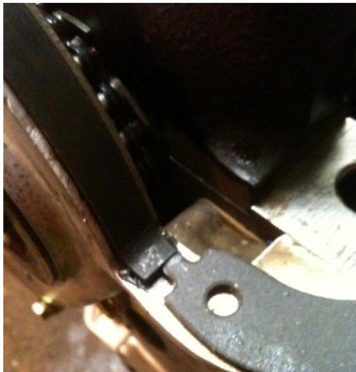
Bei der Montage der Halbringe und der Ölwanndichtungen ist auf das korrekte Einschieben der „Nasen“ in die Gummiringe zu achten.
