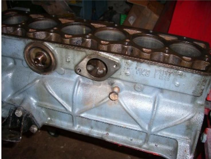
und hier die neuere Ausführung mit Anschluss am Motorblock
