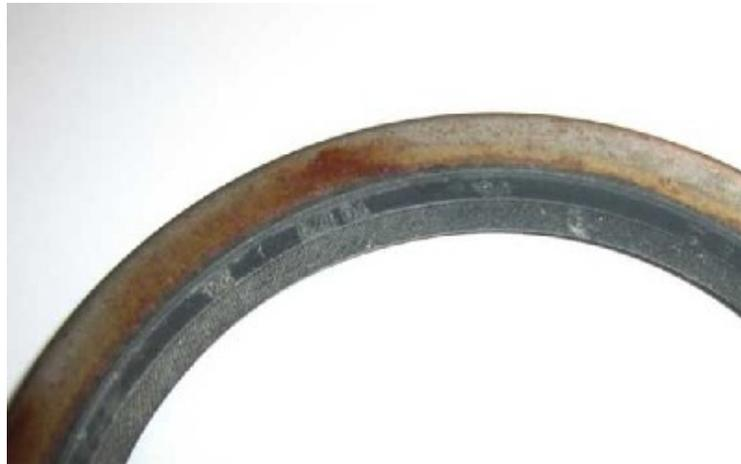
Hoffentlich kann man's erkennen, alter Simmerring mit Rücklaufrillen für linksdrehende Welle (hinterer Simmerring, hier dreht die KW linksherum, von hinten betrachtet)
