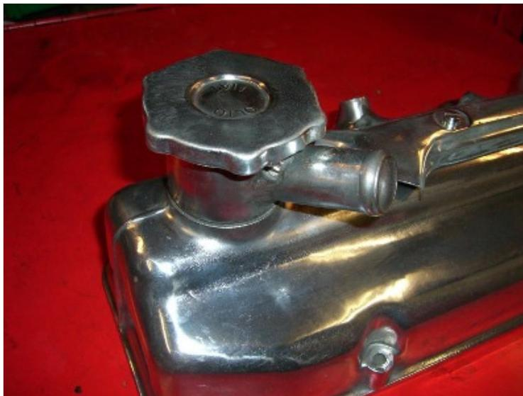
Dies ist die alte Ausführung, an dem verlängerten Einfüllstutzen wird ein Gummischlauch nach unten angeschlossen.
