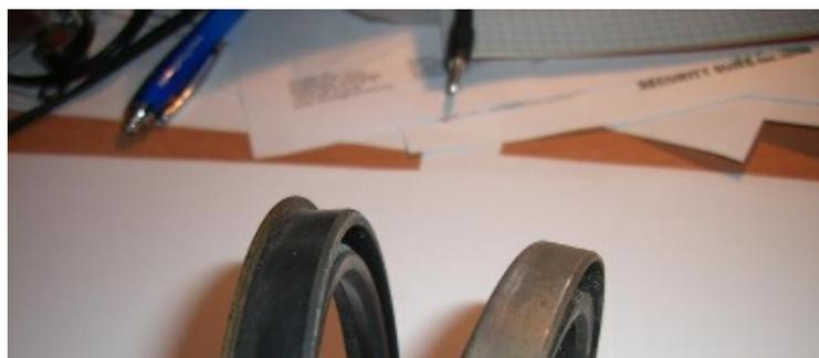
Die ersten Motoren hatten übrigens auch hinten an der Kurbelwelle einen Simmerring mit Kragen, in der Abmessung (105/100x80x10). Dadurch war gewährleistet, dass der Ring beim
