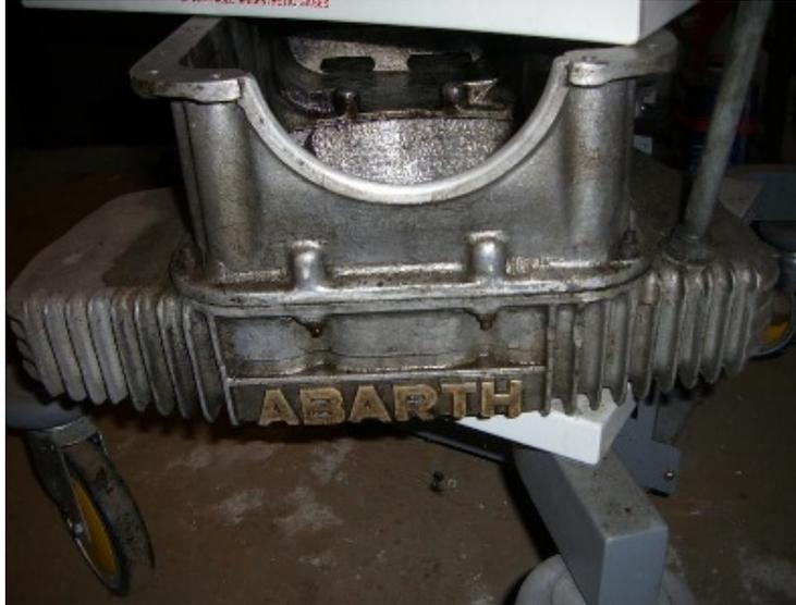
An dieser Stelle eine Anmerkung zu den verschiedenen Ausführungen der Alu-Ölwanne der S Coupés: Es gibt zwei grundsätzliche Bauvarianten: die alte einmal (waagrecht) geteilte und die neuere dreiteilige (zweimal senkrecht geteilt, mit von mir so genannten „Ohren“). Und dann eine ganze Reihe von Untervarianten, die sich z.B. durch den eingegossenen „Abarth“-Schriftzug oder die eingebauten
