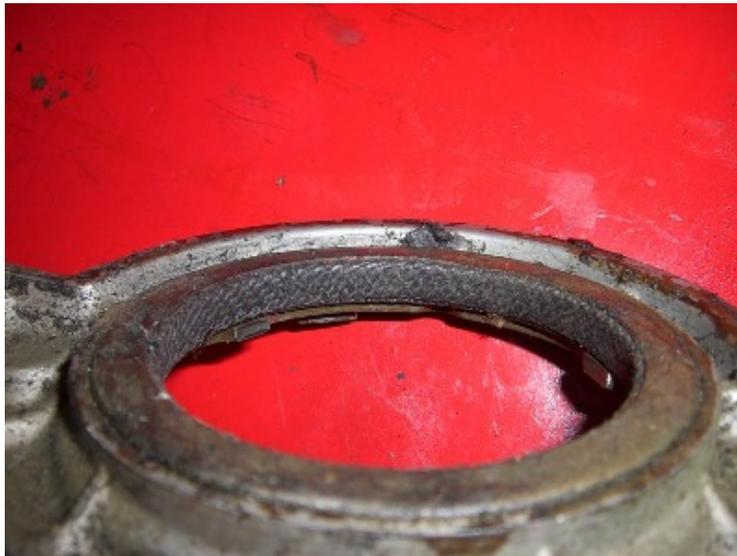
Was kaum jemand noch weiß: die ersten Dichtringe waren keine "Simmerringe" mit Dichtlippen, sondern eine Art Fettschnüre, wie sie heute noch in Hauswasserpumpen eingebaut werden. Die waren rund 9 mm breit und steckten in ähnlichen Metallgehäusen wie sie Simmerringe besitzen.
