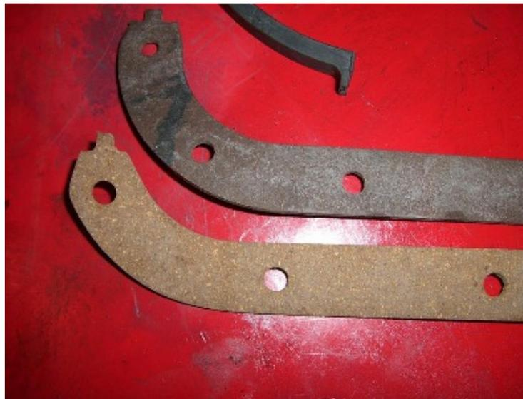
Die Gummi-Halbringe sind auch aus Altbeständen gut verwendbar, immer noch elastisch. Anders sieht es mit den Ölwanndichtungen (links und rechts verschieden) aus. Meist sind die in den Motordichtsätzen aus einem gummiähnlichen rötlichen Material, das sich oft als steif wie ein Brett zeigt. Sowas sollte dann besser nicht verbaut werden. Besser ist dann Naturkork, denn
