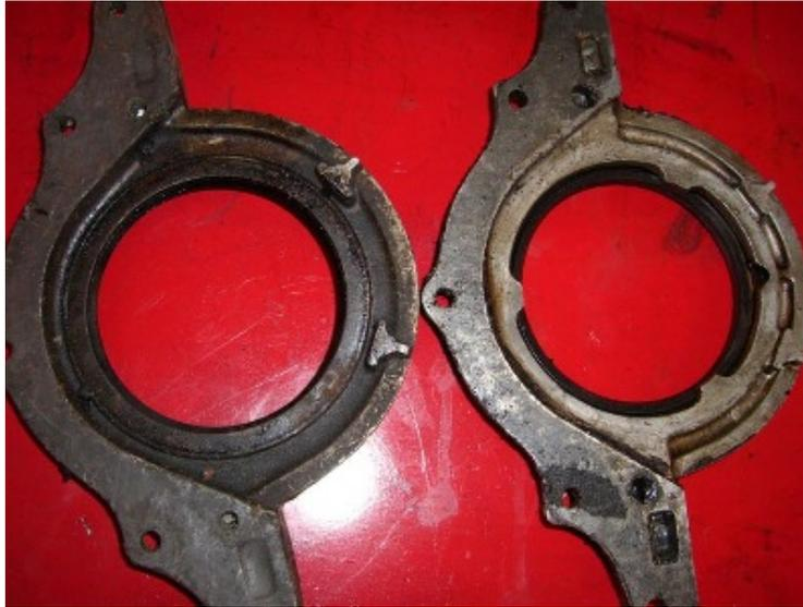
Hinterer Lagerdeckel im Vergleich: links die alte Ausführung ohne Tiefenanschlag für den Simmerring, der brauchte also den "Kragen", rechts die spätere Ausführung mit Tiefenanschlag.
