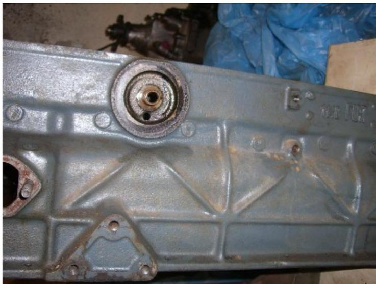
Dies merkte man wohl auch bei FIAT und versah die Motorblöcke auf der linken Seite im hinteren Bereich mit einer zusätzlichen Öffnung oberhalb der Ventilstößel. Auch hier verwirren die Ersatzteilkataloge.
