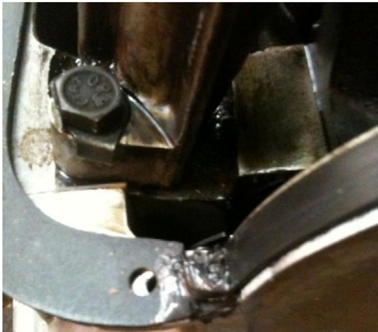
Ohne Dichtmasse läuft gar nichts: Ich verwende Silikondichtmasse schon beim Einsetzen der Halbringe in die Aludeckel (sparsam) und vor allem in den Ecken, wo Halbringe und Ölwanndichtungen aneinanderstoßen. Diese Dichtmasse muss aber so aufgebracht werden, dass sie beim Anziehen der Ölwanne nicht nach innen gedrückt wird, sonst findet man sie beim nächsten Zerlegen des Motors am Sieb der
